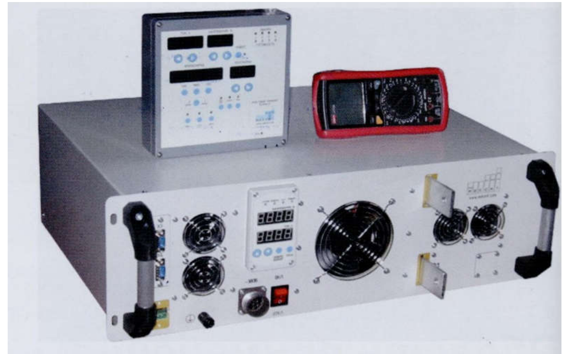
Модуль перетворювача, номінальна потужність - 20 кВт. Вихідний струм - до 1000 А в нереверсивного виконанні, до 800 А з реверсорів.
